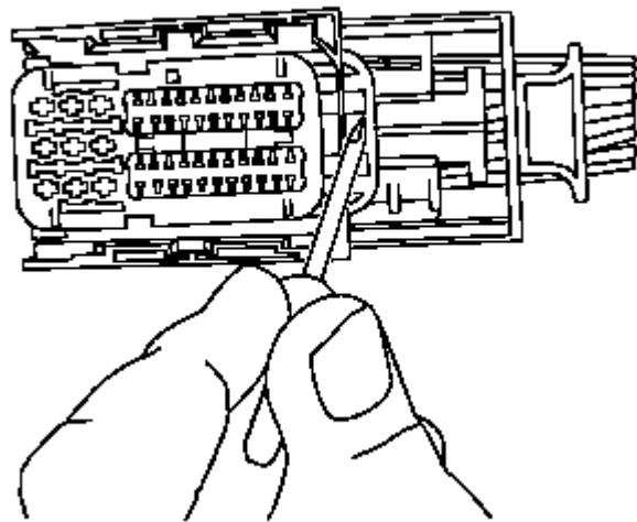
7.用小号平刃工具将后端子定位器从连接器上完全拆下。
