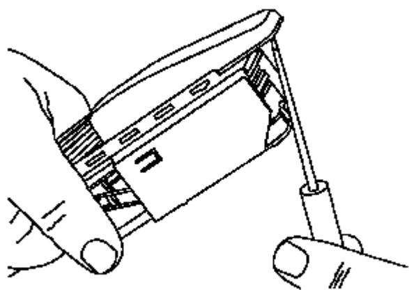
4. 将护盖向前滑离连接器。
