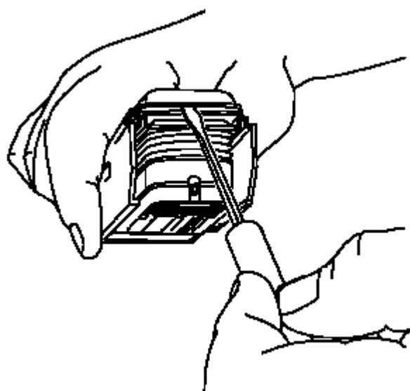
3. 使用小号平刃工具拆下护盖。
